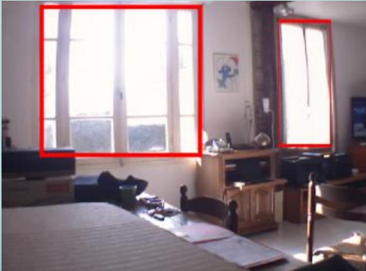
Dans un premier temps, il faut créer une ou plusieurs autres zones sensibles. Ces différentes zones doivent être ajustées en fonction de la pièce à surveiller.
