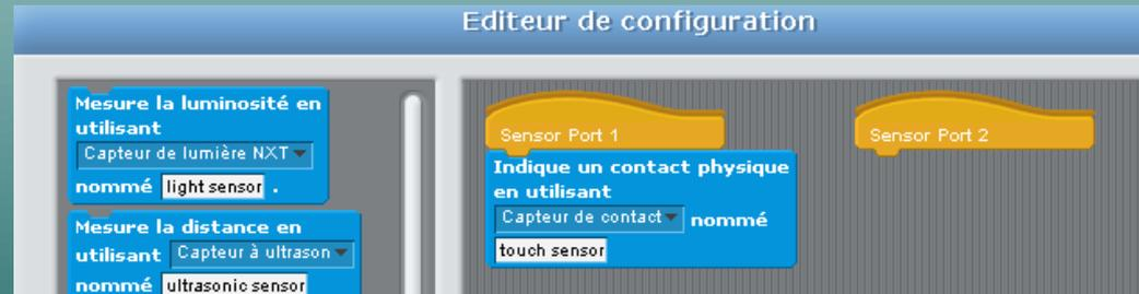
Dans l'éditeur, choisir un capteur de contact. Faire « glisser » le bloc sur le port 1. Il faudra relier le capteur sur l'entrée 1.
